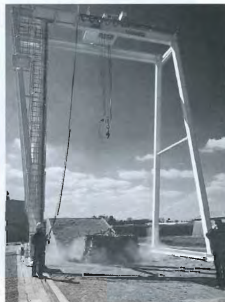
Avant et après un essai de chute verticale sur plan horizontal en terre battue
